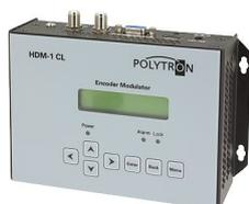
Umsetzer eines Signals von einem Mediaplayer o.ä. bei Anbindung mittels HDMI Kabel. Umsetzung in DVB-T oder DVB-C und Einspeisung in das Antennen-Netz als ein Fernseh-Kanal.
